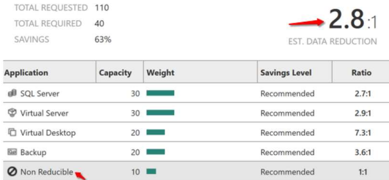
Рис 1. Пример результатов подробного исследования возможностей массивов HPE по оптимизации емкости, занимаемой реальными приложениями заказчика:
